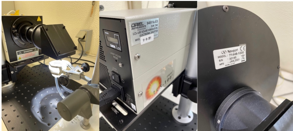
Figura 10. À esquerda e ao centro, o simulador solar da Newport. À direita, o colimador instalado a posteriori.
